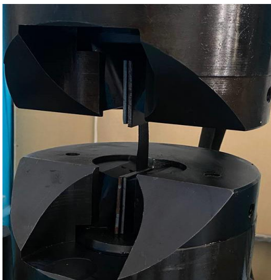
Рисунок 2 - Установка образца «КАПЛАМ 500» в тиски
