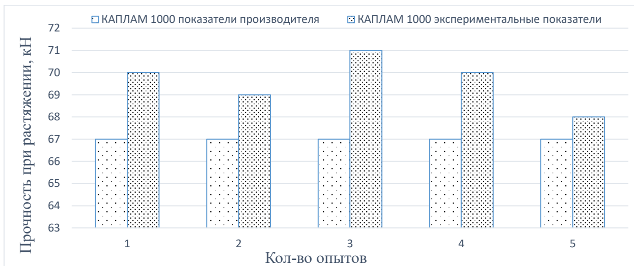
Рисунок 5 - Показатели прочности при растяжении на лабораторных исследованиях материалов «КАПЛАМ 1000»
