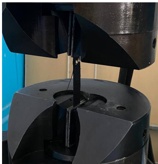
Рисунок 3 - Результат эксперимента «КАПЛАМ 500» на растяжение
