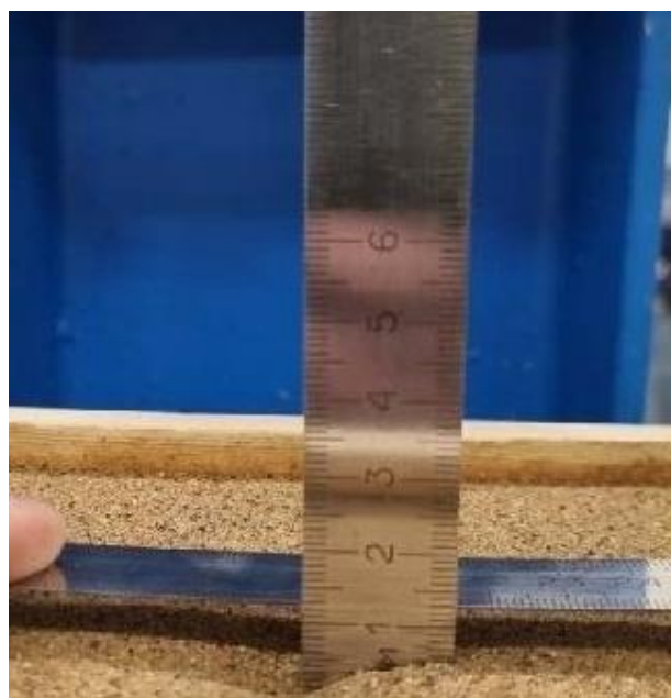
Рисунок 7 - Общий вид зоны продавливания материала «КАПЛАМ»
