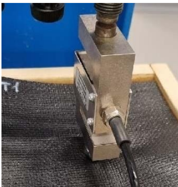
Рисунок 6 - Испытание на продавливание материала «КАПЛАМ»
